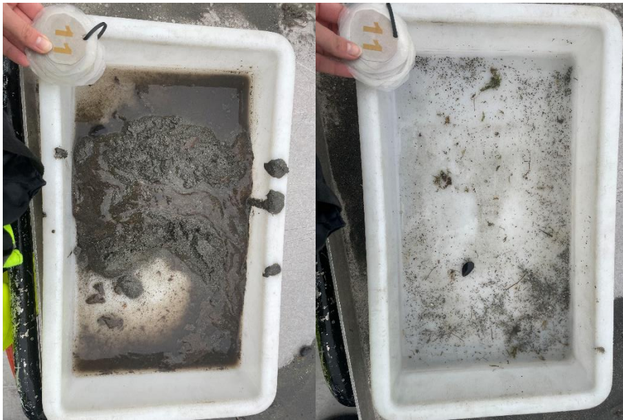
Figur 11: Bilder som viser sedimentet fra stasjon 11 før og etter siling. Sedimentet besto av silt. Foto: Aqua Kompetanse AS.
