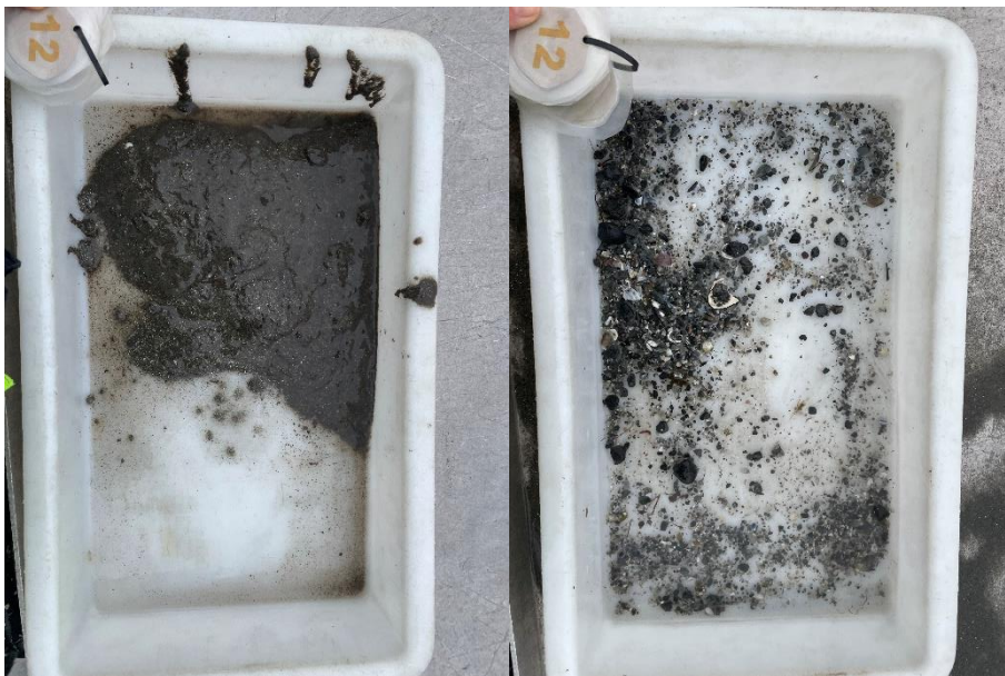
Figur 12: Bilder som viser sedimentet fra stasjon 12 før og etter siling. Sedimentet besto av silt, sand og grus. Det ble registrert rester av fekalier ved stasjonen. Foto: Aqua Kompetanse AS.
