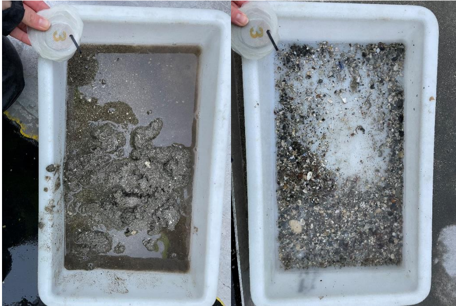
Figur 3: Bilder som viser sedimentet fra stasjon 3 før og etter siling. Sedimentet besto av sand, skjellsand og silt. Foto: Aqua Kompetanse AS.
