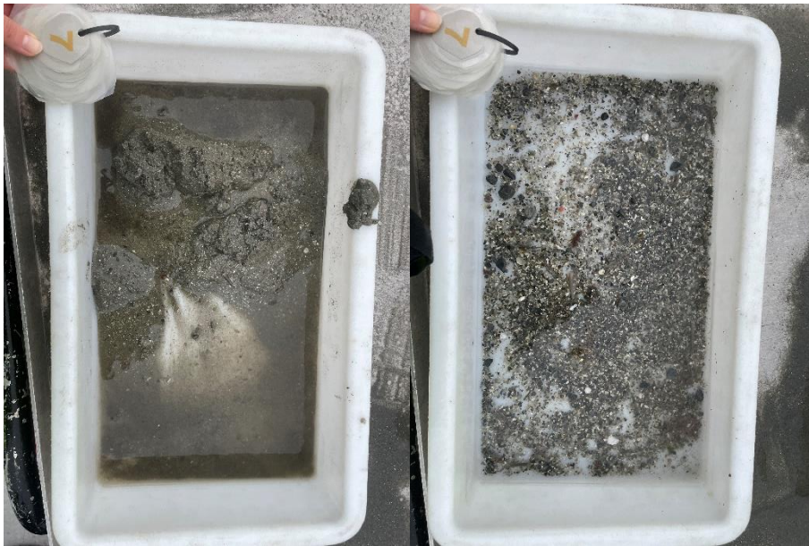
Figur 7: Bilder som viser sedimentet fra stasjon 7. Sedimentet besto av sand og skjellsand. Foto: Aqua Kompetanse AS.
